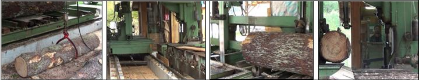
La bille est installée sur le chariot, on commence par enlever les croûtes de la bille.
